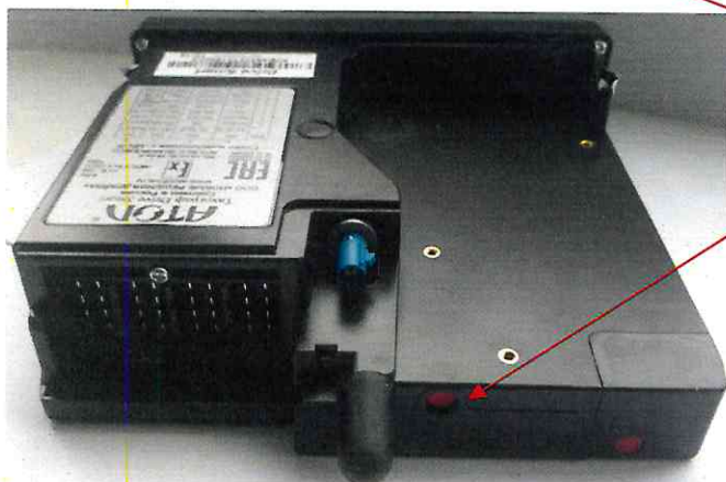
Рисунок 2 – Место размещения знака утверждения типа и схема пломбировки от несанкционированного доступа
